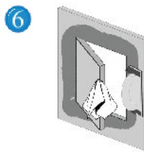
Após o estuque, limpe os dois quadros de qualquer resíduo. Isso é essencial para que a funcionalidade da tampa de inspeção não seja comprometida. Após a secagem, corrija as diferenças de nível.
