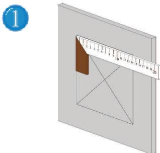
Meça a estrutura externa e com a ajuda de um esquadro, desenhe o perfil da abertura na parede ou teto onde tampa será colocada.
