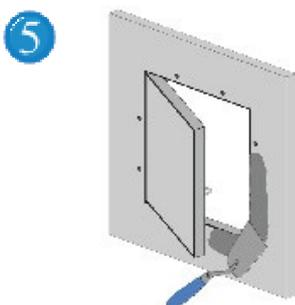
Agora estuque o quadro externo da na parede / teto de gesso acartonado, incluindo os parafusos.
