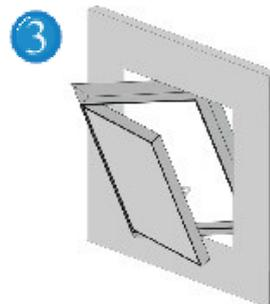
Pegue a tampa e girando-a inserir-la em diagonal através da abertura feita. No caso de aplicação em parede preste atenção que os cliques estejam na parte superior.
