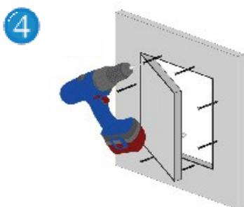
Pressione a estrutura externa contra a parede pela parte traseira e fixe-a na parede / teto de gesso acartonado com parafusos autoperfurantes a uma distância máxima de 17 cm entre eles.
