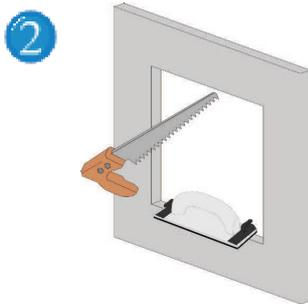
Corte a abertura na parede ou no teto (furo com serrote para drywall). Verifique se os cantos estão retos e livres de detritos.
